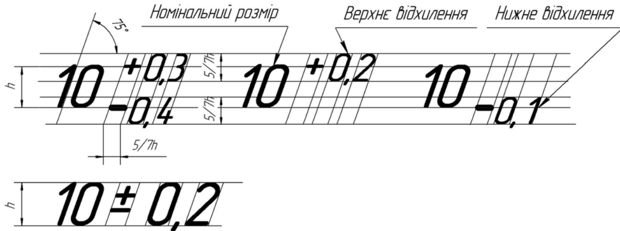
Рис. 1.15. Способи запису числових значень граничних відхилень від номінального розміру деталі
