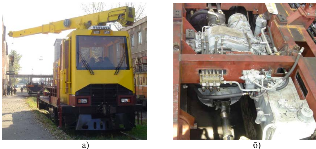
Рис. 3.24. Мотовоз технологический МТ-1: а – общий вид мотовоза; б – ГОМТ, установленная на мотовозе
