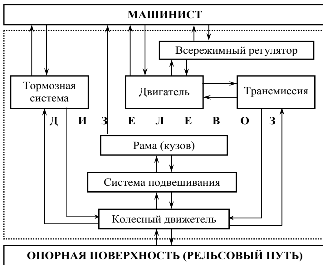
Рис. 4.12. Схема функционального взаимодействия в системе машинист – локомотив – внешняя среда
