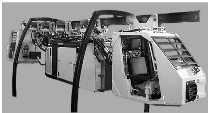
Рис. 1.5. Подвесной дизель-гидравлический локомотив LSP 70.DO
