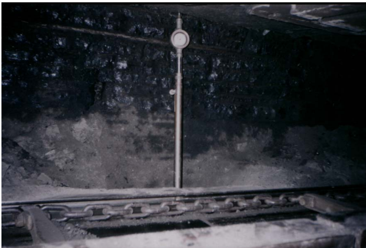
Рис. 2.2. Расположение первой измерительной стойки на замерной станции №5 (секция 53)
