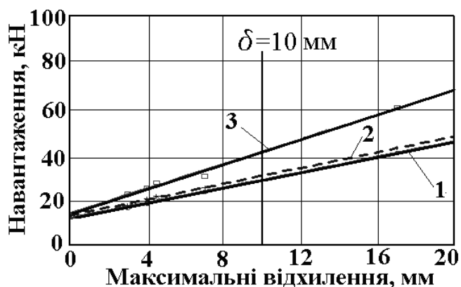
Рис. 9. Залежності контактних навантажень на армування від максимальних відхилень провідників від вертикалі на суміжних ярусах та їх опорної жорсткості: 1 – жорсткість 150 кН/м; 2 – жорсткість 550 кН/м; 3 – жорсткість 750 кН/м
