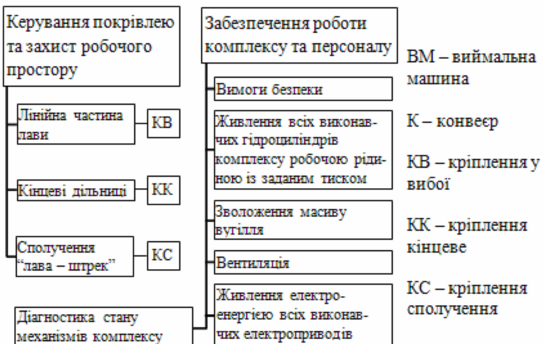
Рис. 2.2. Функціонально-структурна схема очисного механізованого комплексу
