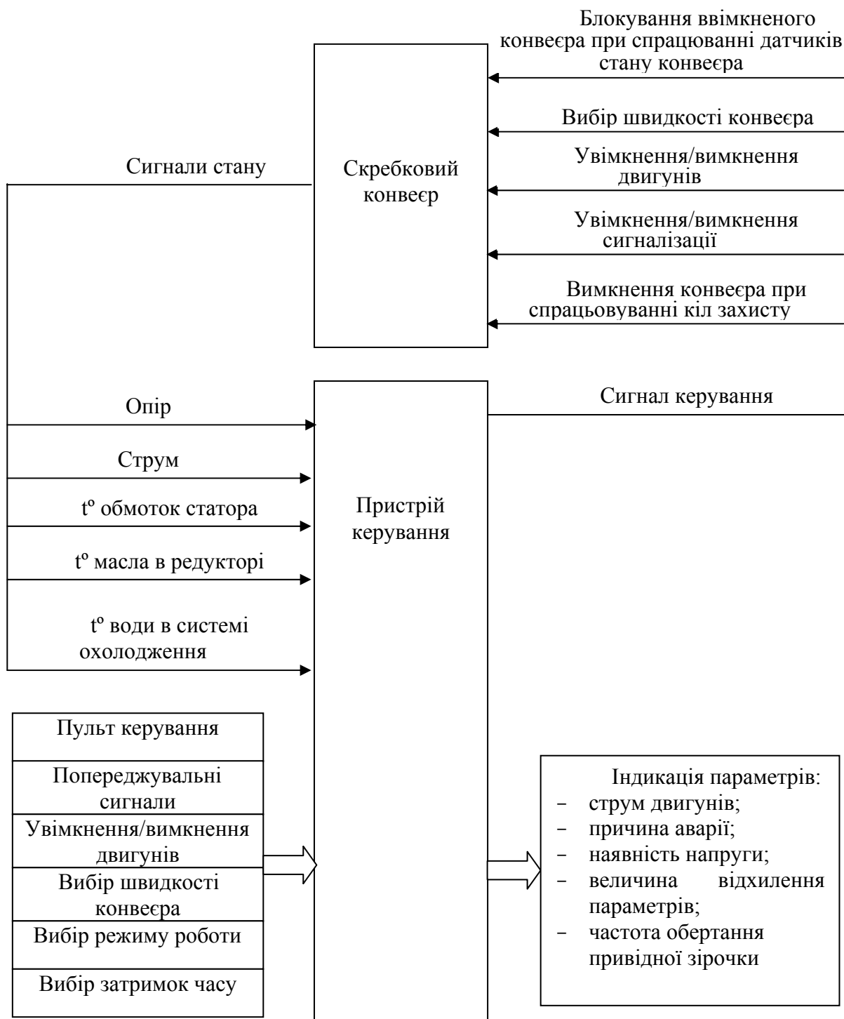
Рис. 2.44. Структурна схема системи керування скребковим конвеєром
