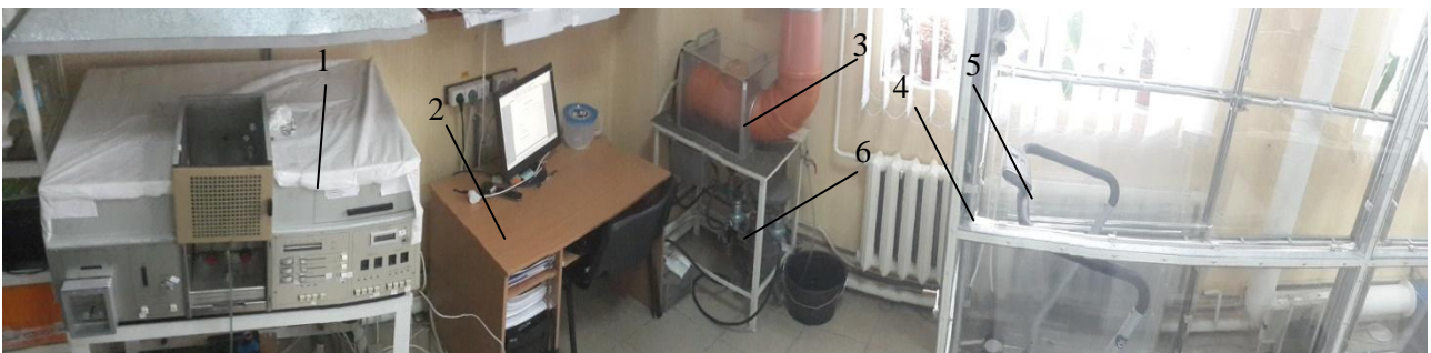
Рис. 4. Загальний вигляд станда з перевірки ЗІЗОД на людях: 1 – полуменевий спектрофотометр; 2 – комп'ютер для отримання результатів; 3 – генератор аерозолі; 4 – випробувальна камера; 5 – бігова доріжка; 6 – система подачі стислого повітря
