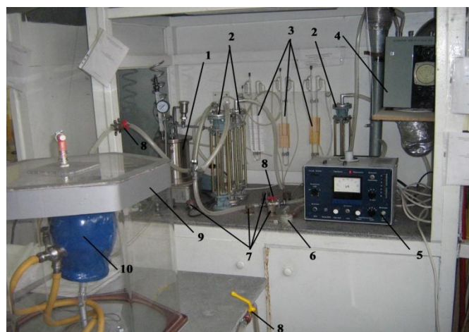
Рис. 5. Загальний вигляд станда з перевірки ЗІЗОД на муляжі: 1 – генератор аерозолі; 2 – ротаметри; 3 – мікроманометри рідинні; 4 – аспіратор; 5 – інтегральний фотометр; 6 – триходовий вентиль; 7, 8 – регульовані вентилі; 9 – випробувальна камера; 10 – спеціальна насадка для закріплення півмаски або муляж голови
