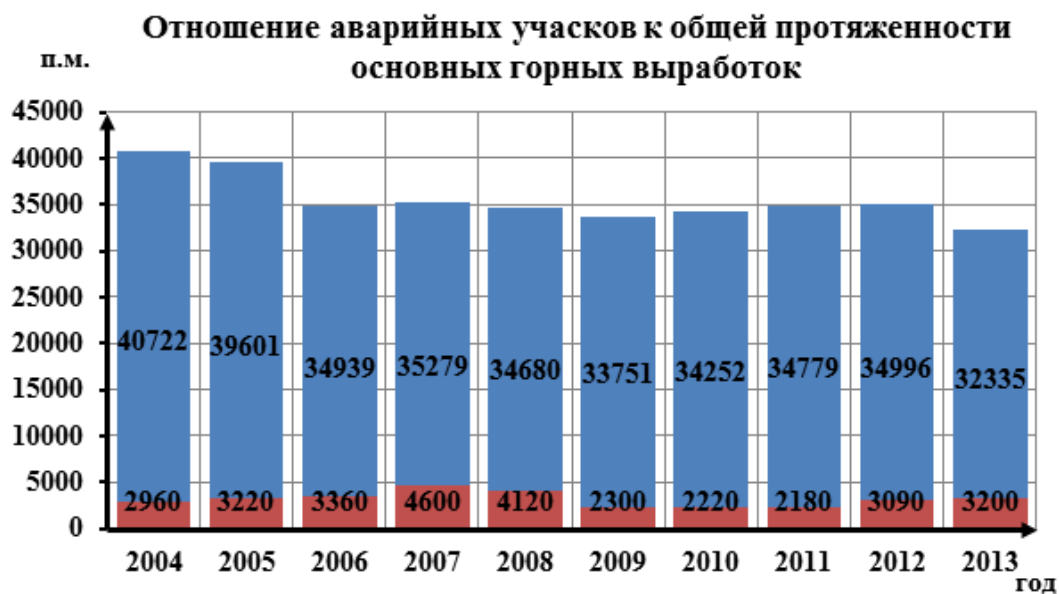
Рис. 6. Общая протяженность участков основных выработок, не соответствующих ПБ
