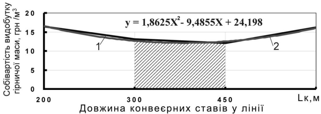
Рис. 5. Графіки залежності довжини окремих конвеєрних ставів у загальній лінії від собівартості видобутку гірничої маси при розкритті нижніх горизонтів довжиною 1800 і 900 м із застосуванням драглайнів ЕШ-20/90: 1 – розрахункова залежність; 2 – поліноміальна залежність
