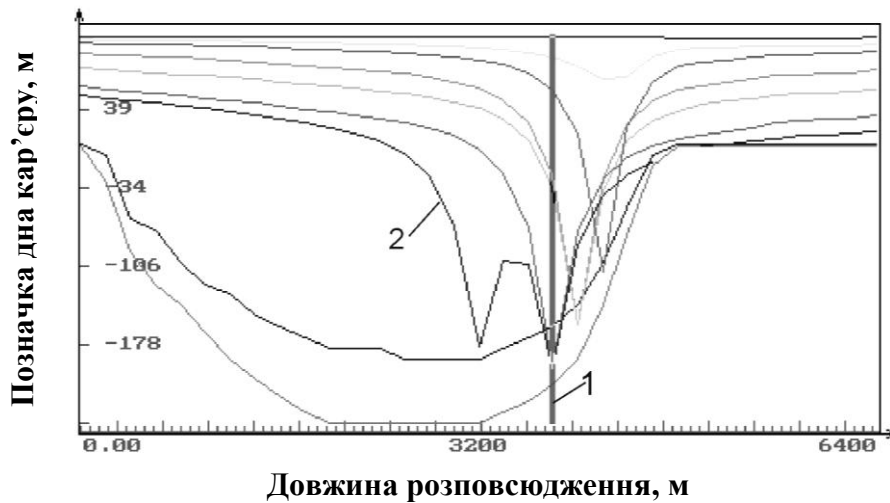
Рис. 1. Параметри впливу воронки депресії на горизонти, що розкриваються: 1 – серія дренажних виробок у кар'єрному полі; 2 – зміна положення лінії депресійної воронки у процесі відкачування води
