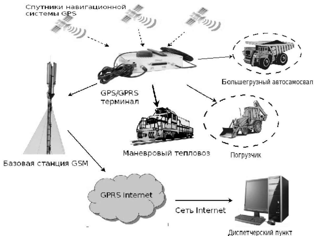
Рис. 2. Принципиальная структурная схема системы контроля и управления за работой маневровых тепловозов
