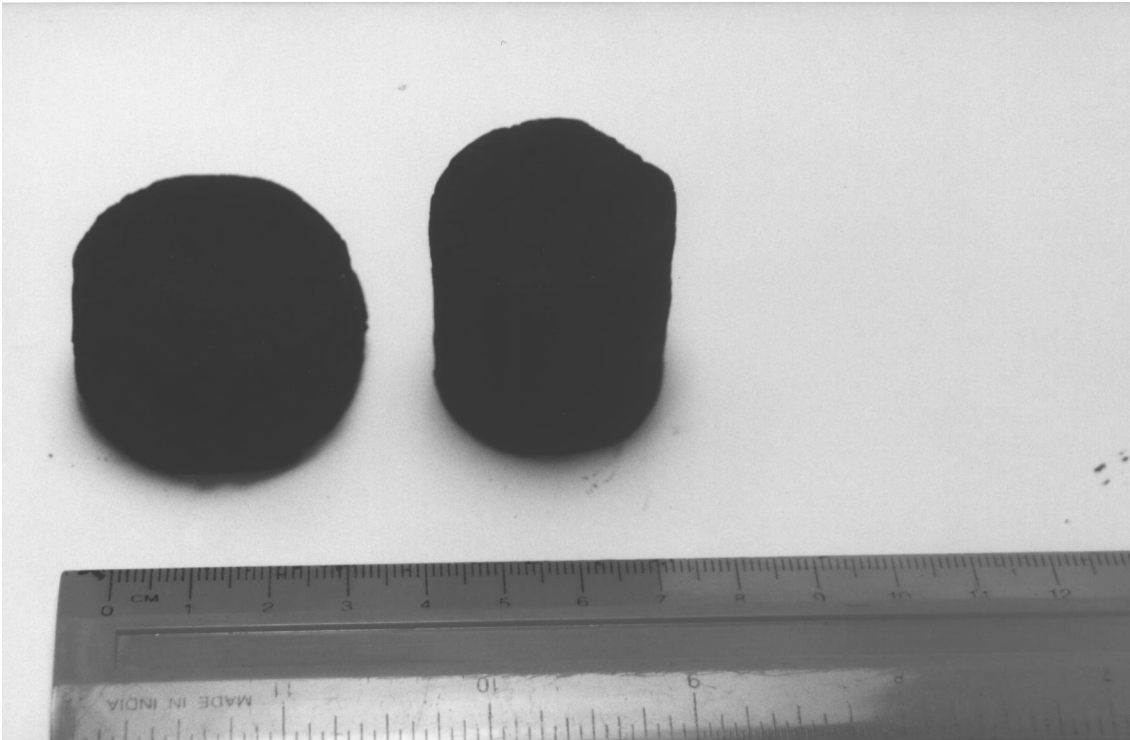
Рисунок 2.2 – Зразок огрудкованого палива, який піддавався навантаженню – ліворуч; контрольний зразок – праворуч
