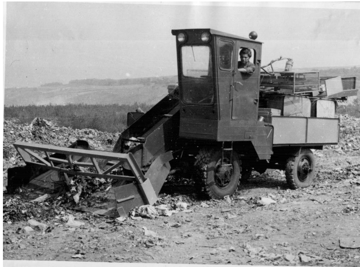
Рисунок 4.2 – Установа для вилучення металів з ТПВ на базі снігонавантажувача з лаповим огорожним органом
