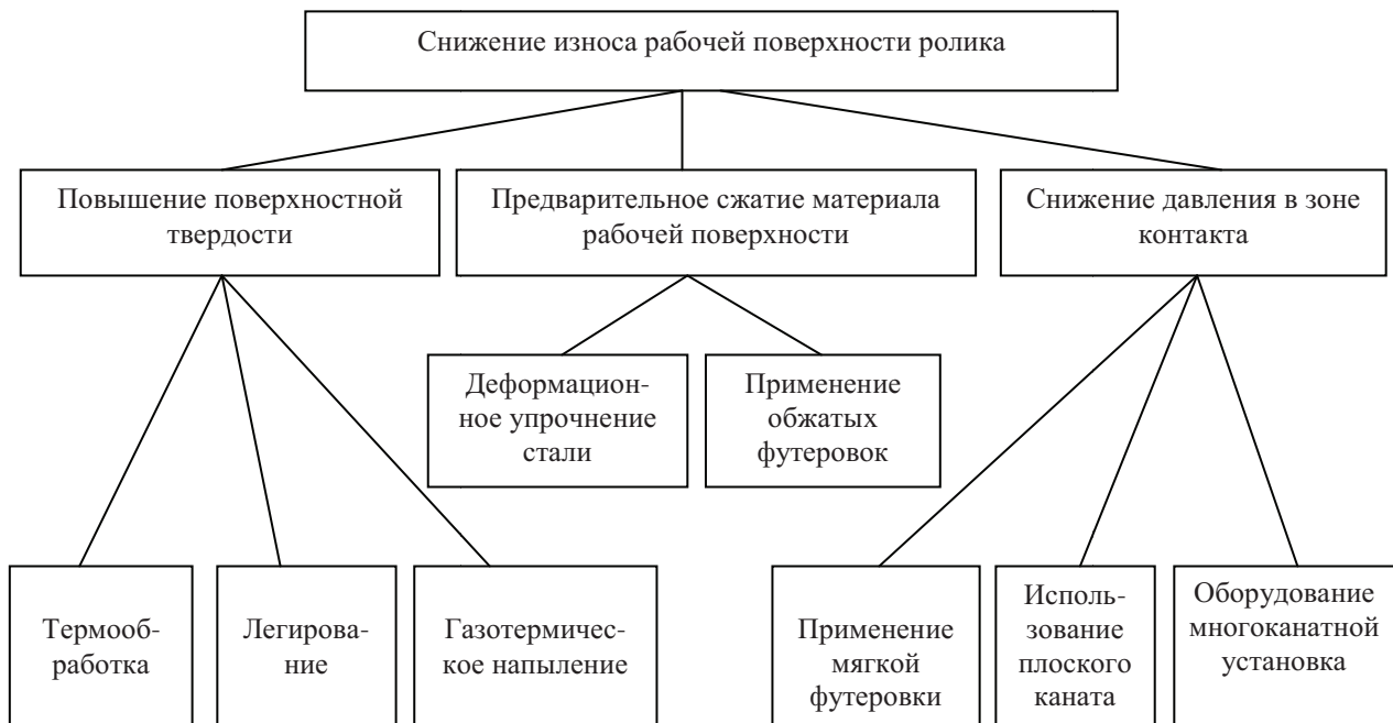
Рис.4.4. Способы снижения износа рабочей поверхности элементов ДКН
