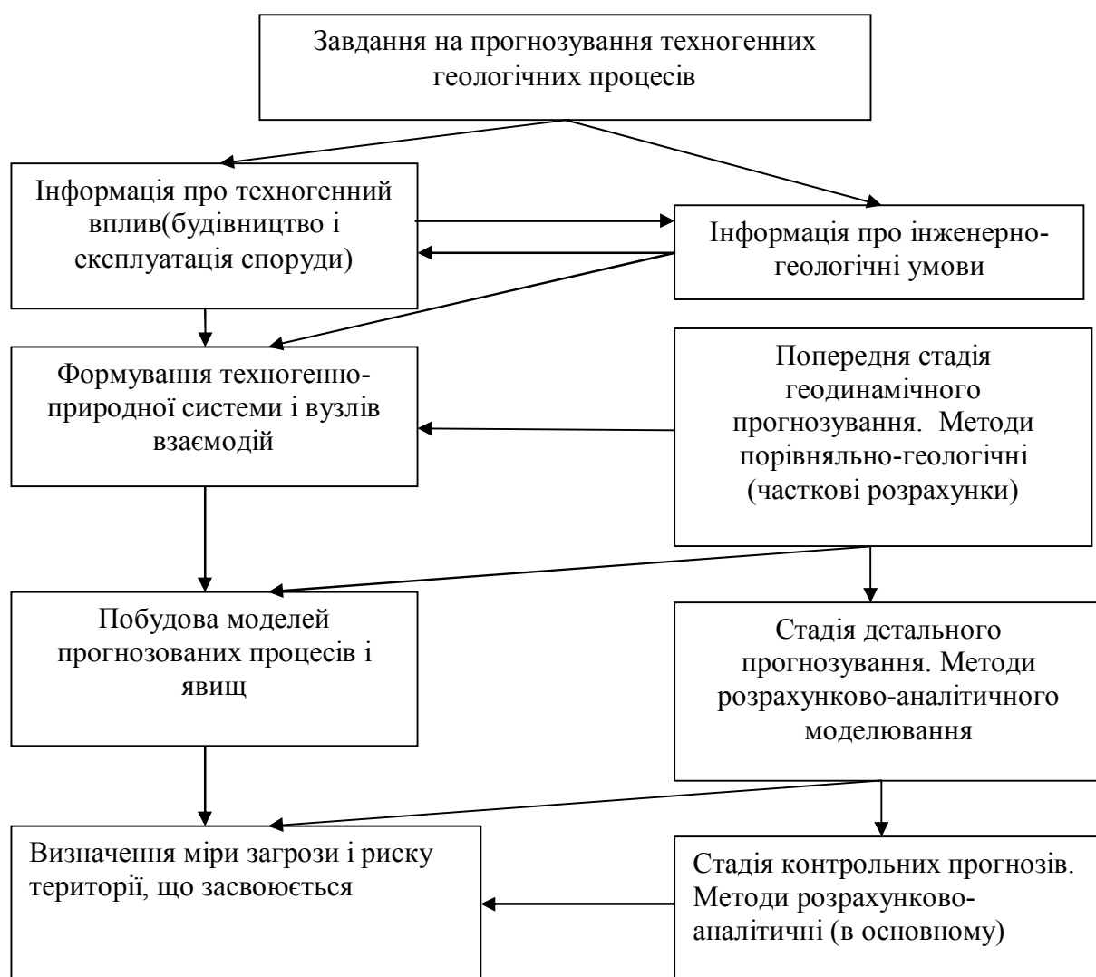
Рисунок 2.23 – Алгоритм прогнозування техногенних геологічних процесів
