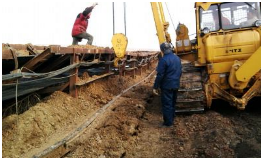
Рисунок 3.6 – Схема роботи трубоукладача при переміщенні стрічкового конвеєра у вибої
