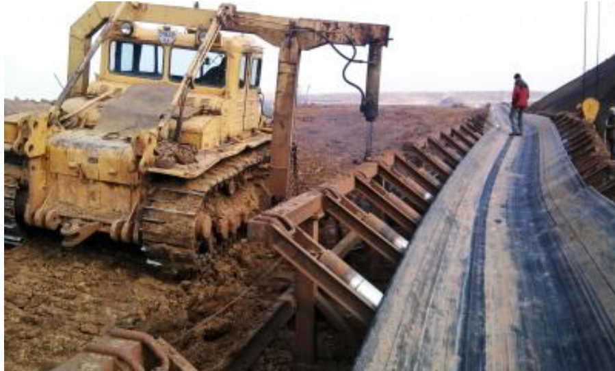
Рисунок 3.4 – Схема пересувки стрічкового конвеєра турнодозером
