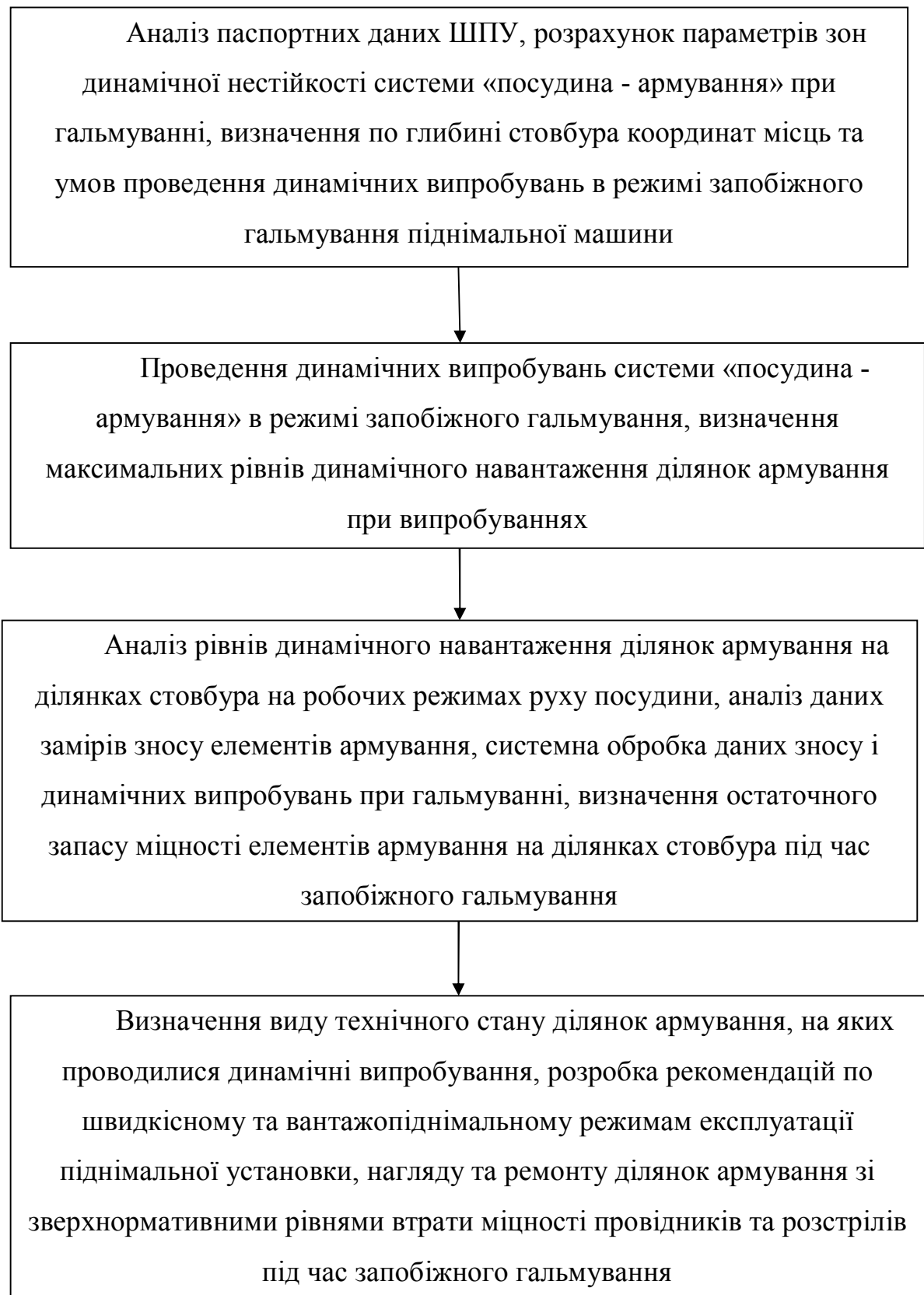
Рисунок 3.1 – Схема проведення діагностики систем «піднімальна посудина - армування» при запобіжному гальмуванні
