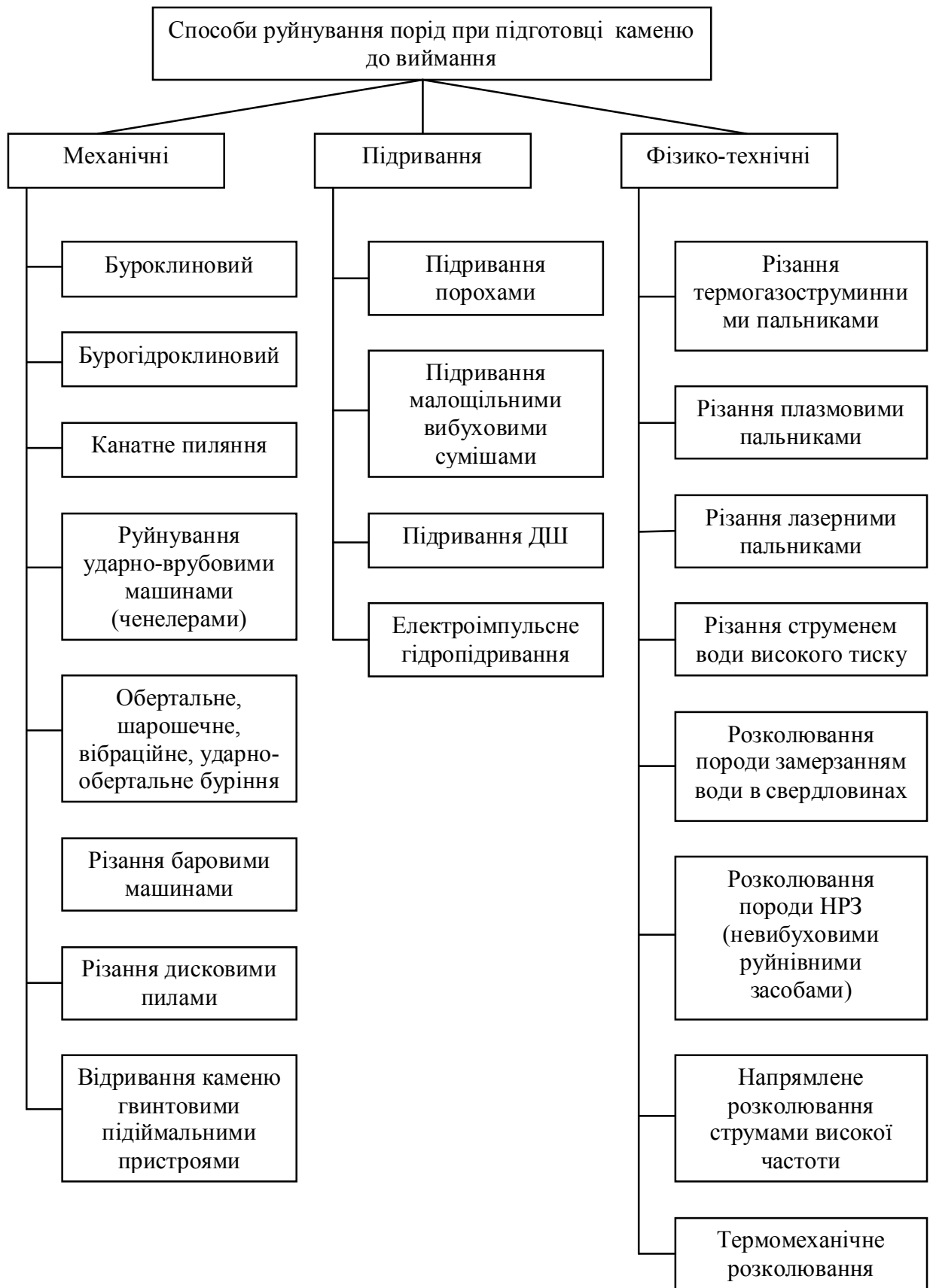
Рисунок 3.1 – Класифікація способів руйнування каменю для підготовки його до виймання
