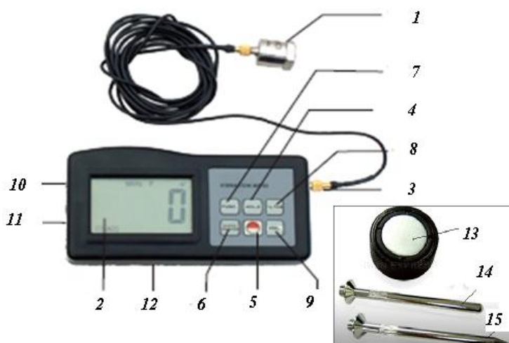
Рис.3. Виброметр VM6360: 1– акселерометр, 2 – дисплей, 3 – входной разъем, 4 – кнопка функций удержания максимальных значений, 5 – кнопка питания, 6 – кнопка преобразования системы единиц измерения, 7 – кнопка функции, 8 – кнопка фильтра, 9 – кнопка звука, 10 – разъем для наушников, 11 – разъем RS232C, 12 – крышка батарейного отсека, 13 – магнитный датчик, 14 – шаровой зондовый датчик, 15 – конусный зондовый датчик
