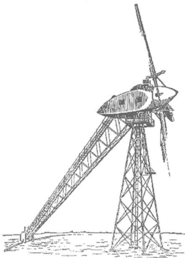
Рисунок 1.3 – Загальний вигляд Балаклавської ВЕС потужністю 100 кВт
