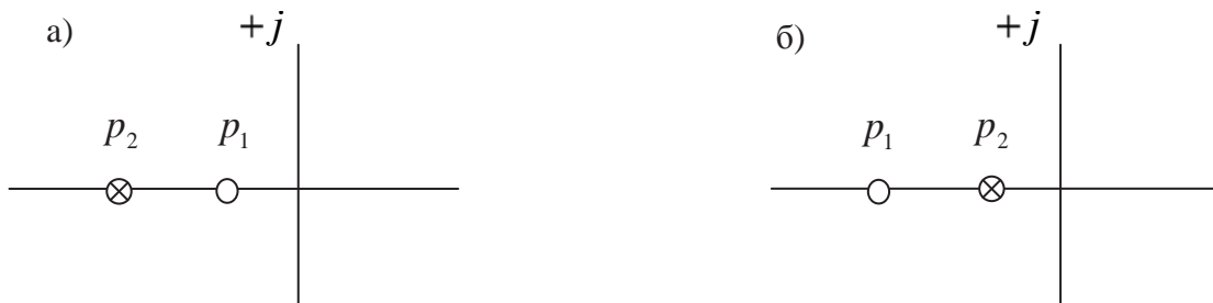
Рисунок 3.8 – Положення полюса та нуля для корекції з випередженням та відставанням за фазою
