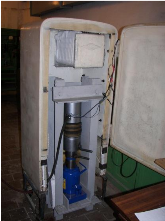
Рис. 2.3. Лабораторная установка по получению газовых гидратов: а – НПО-1; б – НПО-2; в – НПО-3; г – НПО-4 на основе климатологической камеры «ИЛКА» КТК-3000
