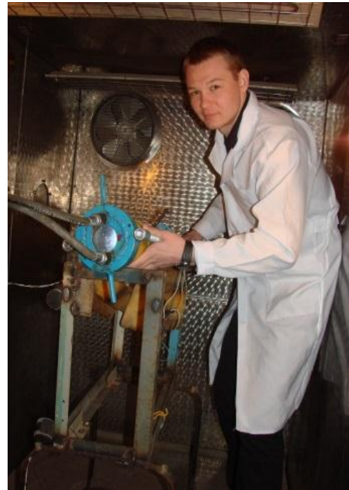
Рис. 2.3. Лабораторная установка по получению газовых гидратов: а – НПО-1; б – НПО-2; в – НПО-3; г – НПО-4 на основе климатологической камеры «ИЛКА» КТК-3000
