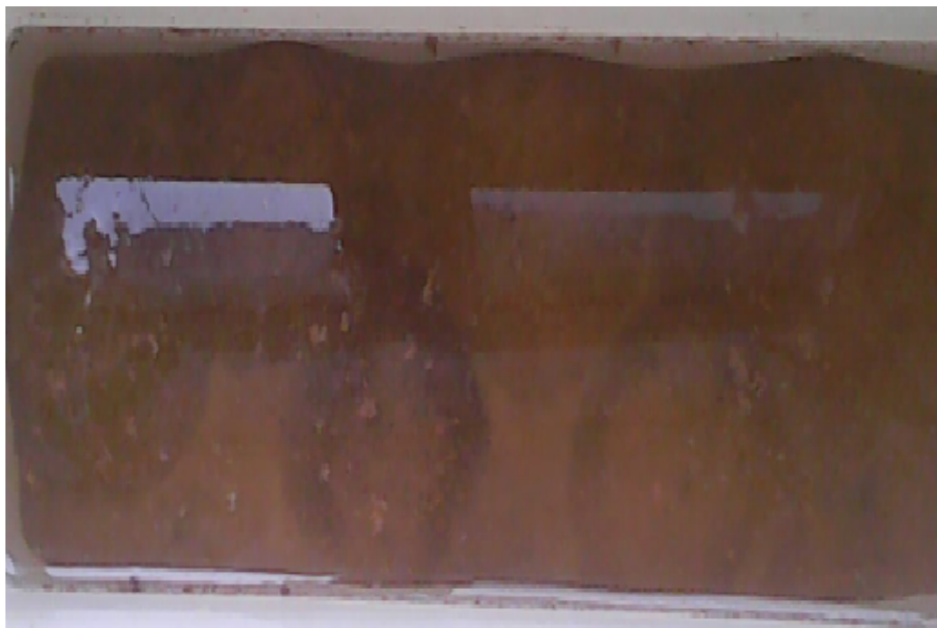
Рис. 4.3. Ґрунтові зразки в замерзлому стані (перший цикл заморожування-розморожування)
