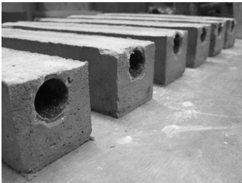
Рис. 4.27. Розташування полімерної труби в бетонному зразку
