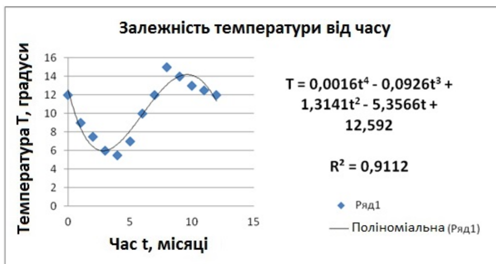
Рис. 3.23. Зміна температури в ґрунтовій основі в м. Дніпропетровську на глибині 3,2 м. Ряд 1 – дані Гідрометеоцентру
