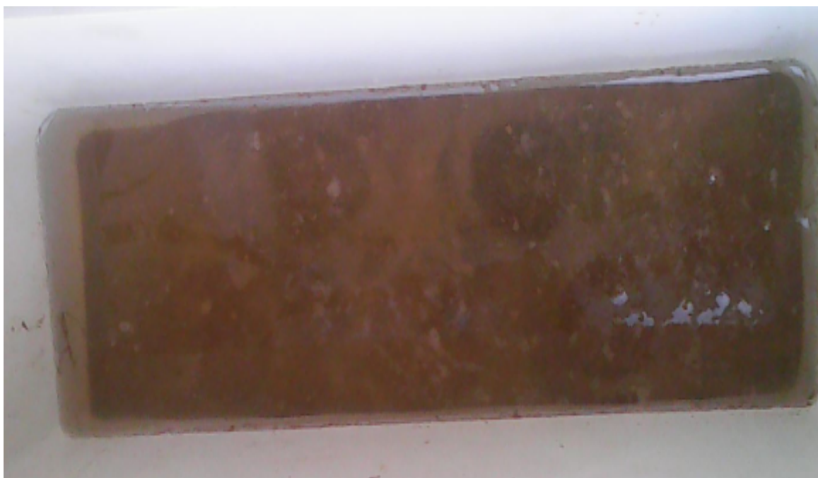
Рис. 4.7. Ґрунтові зразки після розморожування (четвертий цикл заморожування-розморожування)
