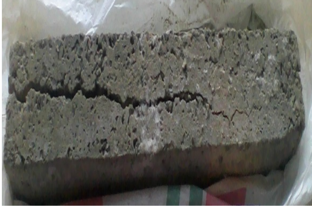
Рис. 4.30. Наскрізні тріщини в бетонному зразку, зумовлені заморожуванням води, яка знаходиться всередині порожнини
