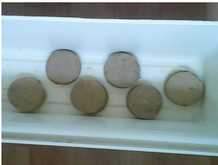
Рис. 4.2. Ґрунтові зразки. Початковий стан (перед зануренням у воду і заморожуванням)
