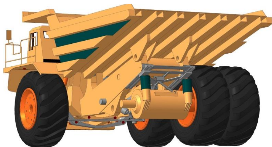
Рисунок 3.2 – Механизм изменения положения центра масс и межосевого расстояния автосамосвала с МЦМ
