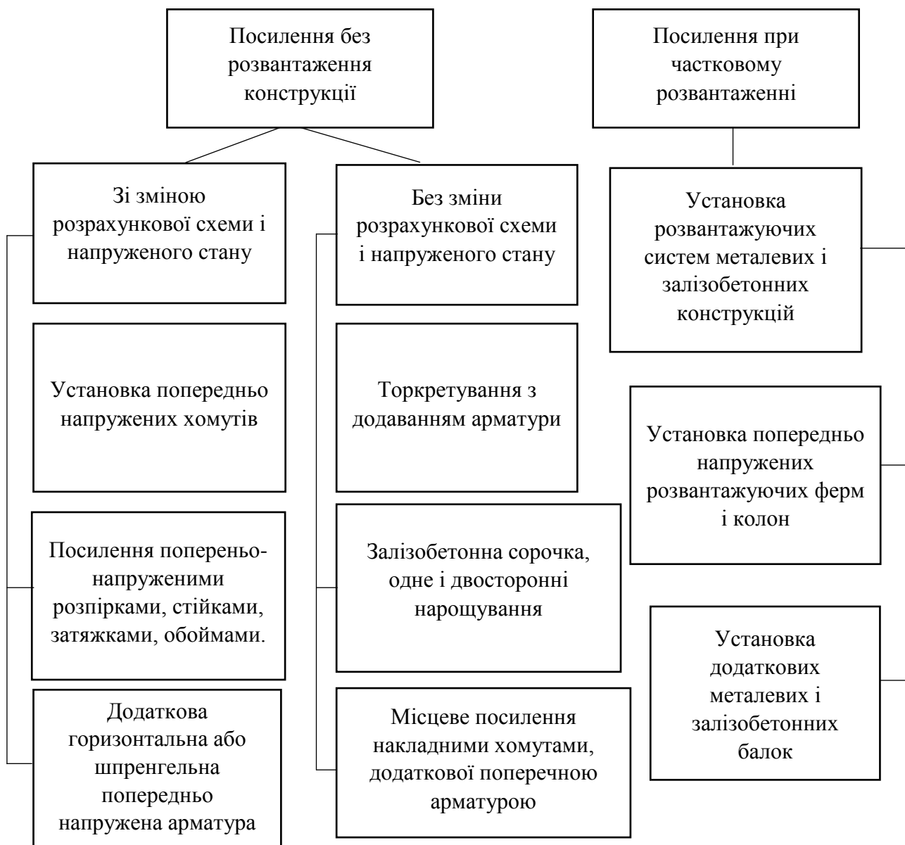
Рис. 1. Способи посилення будівельних конструкцій
