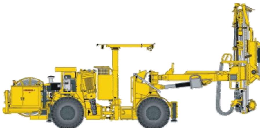
Рис. 8.11. Загальний вигляд установки для кріплення анкерами Voltec 235 H-DCS
