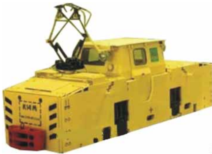
Рис. 10.5. Загальний вигляд контактної електровоза К14М
