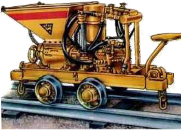
Рис. 7.16. Загальний вигляд зарядної машини ЗМБС-2
