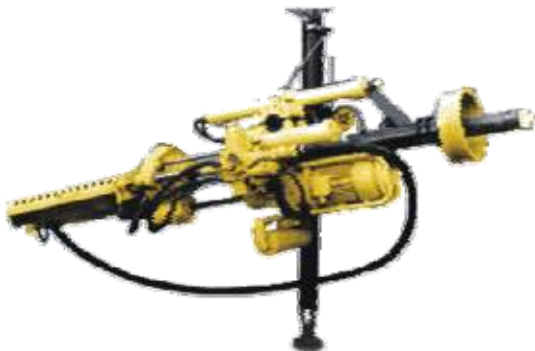
Рис. 3.3. Загальний вигляд бурового верстата типу НКР-100
