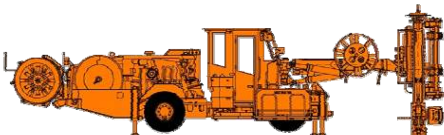
Рис. 8.32. Загальний вигляд установки для кріплення тросовими анкерами Cabolt 7-5 Cabin
