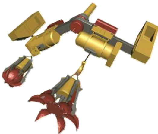
Рис. 5.59. Загальний вигляд стовбурної вантажної машини 2КС-2у/40
