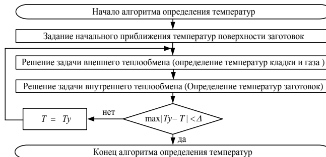
Рис. 4. Алгоритм определения температур внутреннего пространства проходной печи
