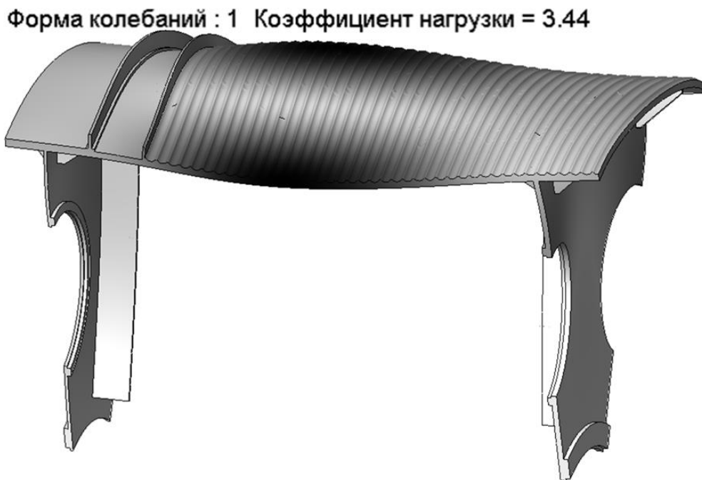
Рис. 5.7. Результаты проверки устойчивости заклиненной части барабана ЦР – 6×3,4/0,6 без шпангоутов
