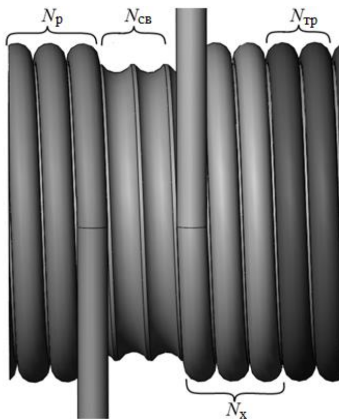
Рис. 2.1. Модель распределения витков на заклиненной части барабана ШПМ
