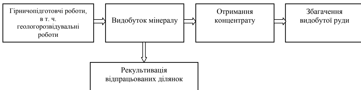
Рис.1. Схема технологічного процесу видобутку і збагачення розсіпних руд
