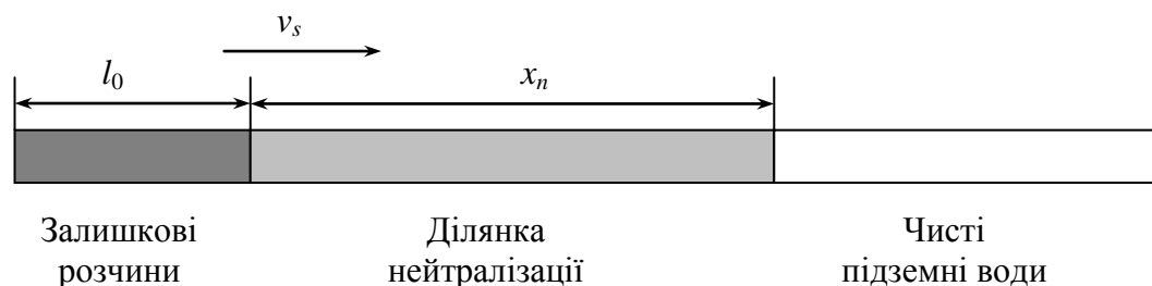
Рис. 7.6. Схема нейтралізації залишкових розчинів у фільтраційному потоці
