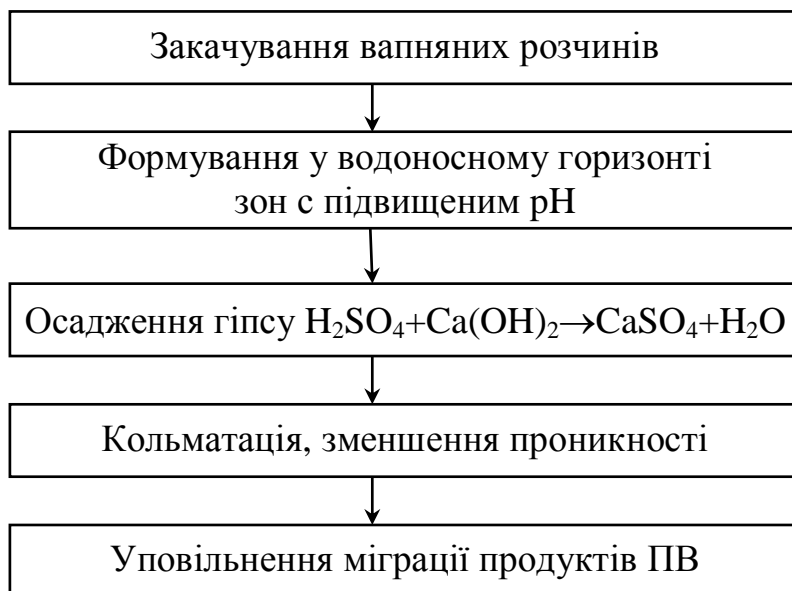
Рис. 7.8. Принципи фізико-хімічної нейтралізації залишкових розчинів ПВ
