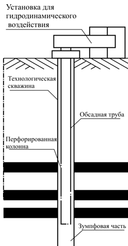
Рис. 3 – Дегазация угольного массива через скважины, пробуренные с поверхности.
