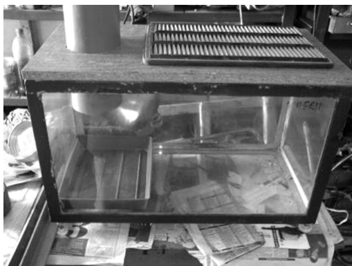
Рис. 2. Отстойник-пылеуловитель, используемый в опытной установке
