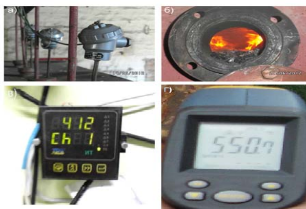
Рис. 2 – Розпалення і термообробка реакційного каналу з фіксацією температурного режиму: а, в – на термопарах, закладених в безпосередній покрівлі над вогневим вибоєм в стаціонарному режимі з виводом даних на цифровий дисплей та інтерфейс; г) - пірометр в динамічному режимі; б) - стадія розпалення і термообробки реакційного каналу
