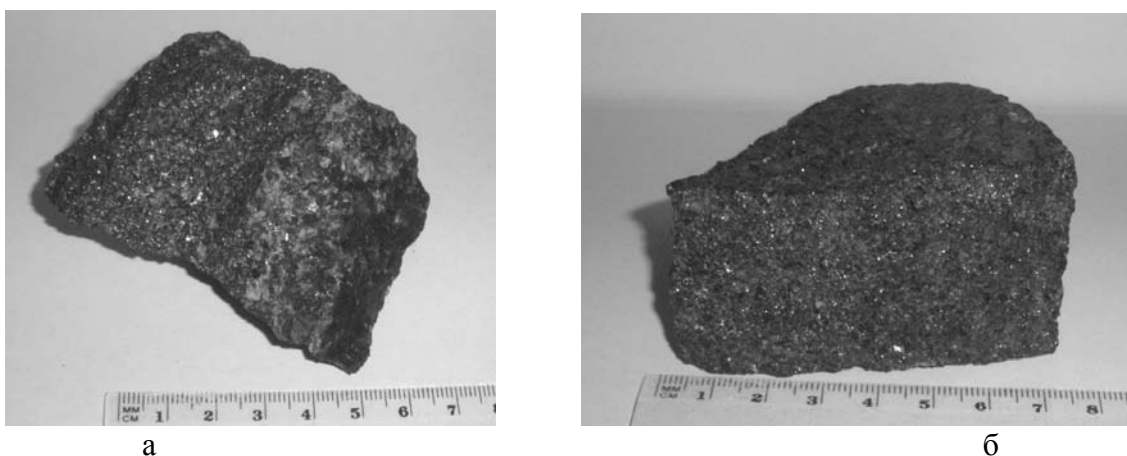
Рис.1. Структурно-текстурні особливості габро-перидотитів (а) і перидотитів (б), що складають технологічну пробу титаномагнетитової руди Кропивенського родовища. а – рядова проба 5/3; б – рядова проба 9/4.
