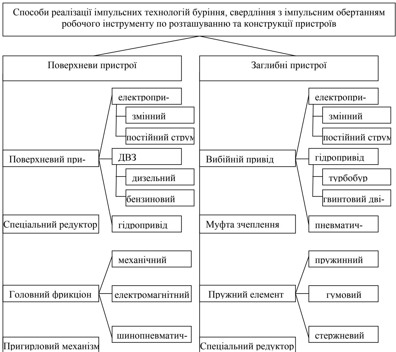
Рисунок 3 – Класифікація способів реалізації імпульсних технологій буріння, свердління з імпульсним обертанням робочого інструменту по розташуванню та конструкції пристроїв
