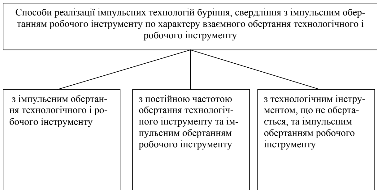
Рисунок 4 – Класифікація способів реалізації імпульсних технологій буріння, свердління з імпульсним обертанням робочого інструменту по характеру взаємного обертання технологічного і робочого інструменту
