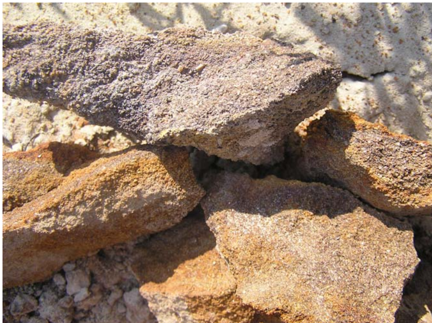
Рис.3 – Образцы песчаника из коры выветривания песчаного карьера, имевшие фиолетово-синие цвета на сколах, позже ставших желто-бурыми
