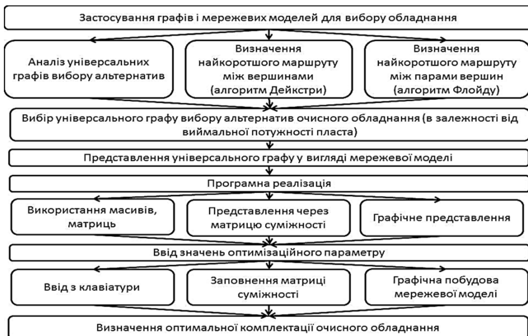
Рис. 1. Методологія вибору, оптимізації, впорядкування комплектацій очисного обладнання з використанням графів та мереж
