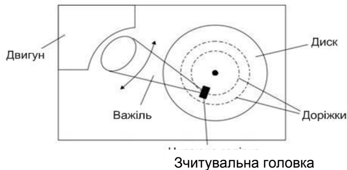
Рис. 6. Загальна схема СК зчитуванням інформації з диска та будова дисководу
