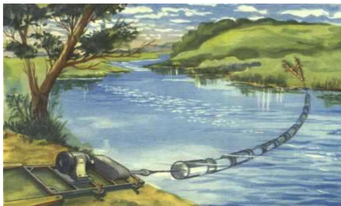
Рисунок 1.8. Виды микро-ГЭС свободопроточного типа:
