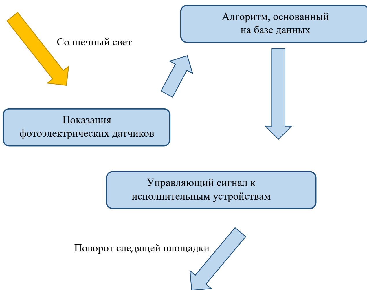
Рисунок 2.5 – Принцип работы гибридной системы слежения с обратной связью.
