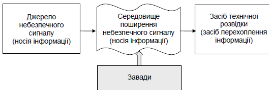
Рисунок 1.1 - Узагальнена структура технічного каналу витоку інформації
