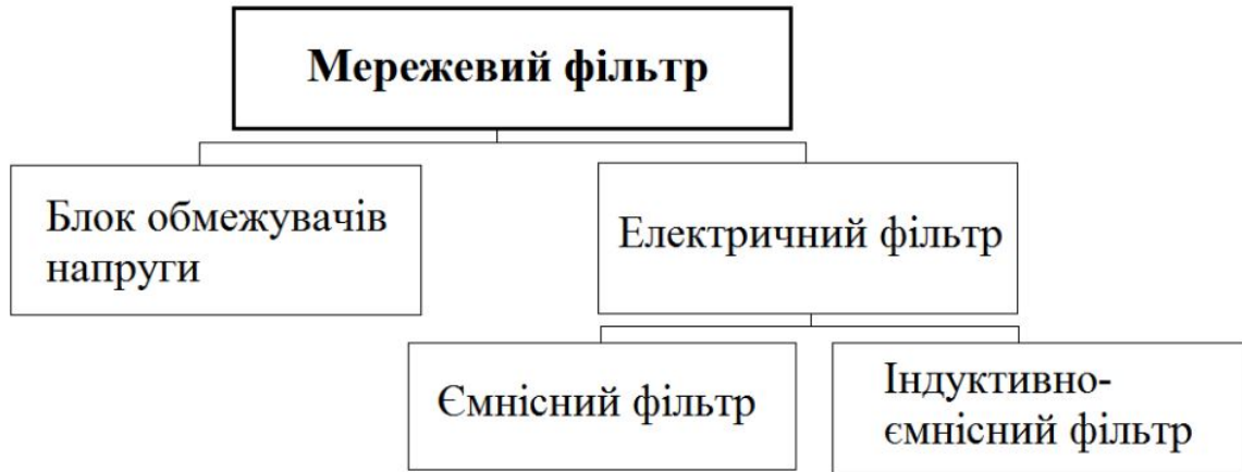
Рисунок 2.1 – Складові мережевого фільтра
