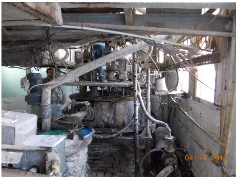
Рис. 2. Пилотная установка экстракции фосфорной кислоты
