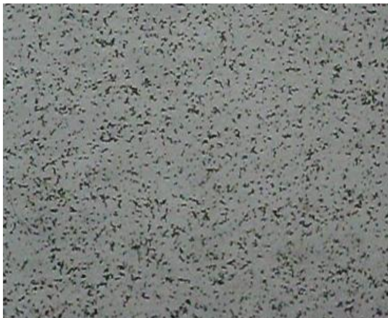
Рис. 2. Суспензия из размагниченных частиц магнетита
