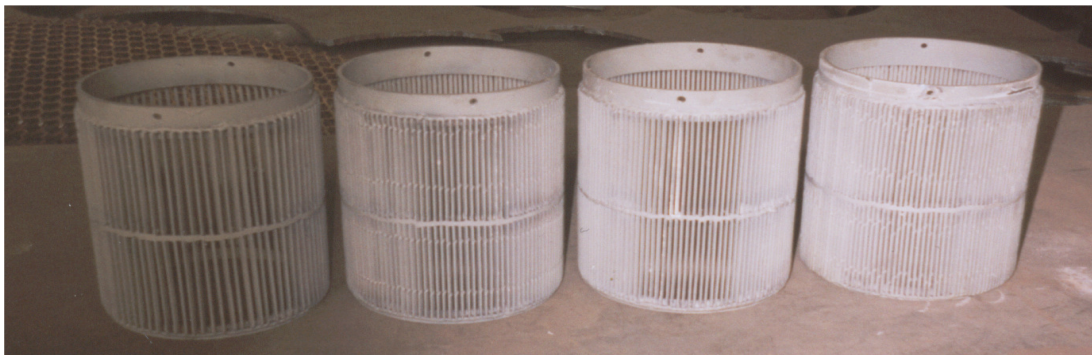
Рис. 5. Шпальтовые цилиндрические сита с щелью размером 4; 2; 1; 0,5 мм
