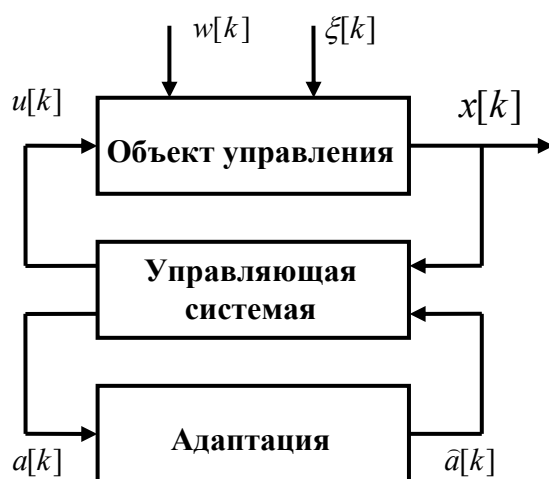
Рис.2.2. Обобщенная структура адаптивной системы управления
