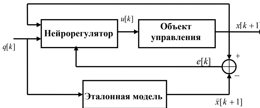
Рис.2.4. Нейросетевая система управления с эталонной моделью
