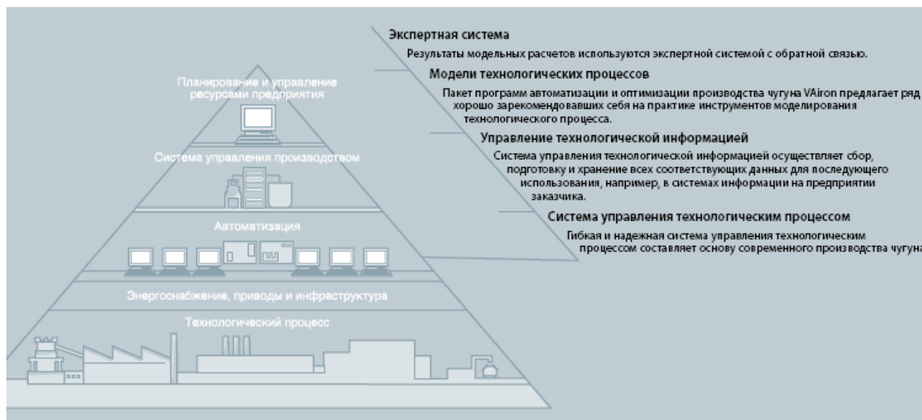
Рис. 1.4. Структура системы оптимизации VAiron
