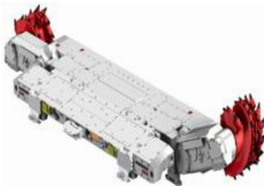
Рис. 1. Загальний вигляд очисного комбайну УКД 200-250, на корпусі якого червоними цятками вказано розташування форсунок зрошення для боротьби з пилом
