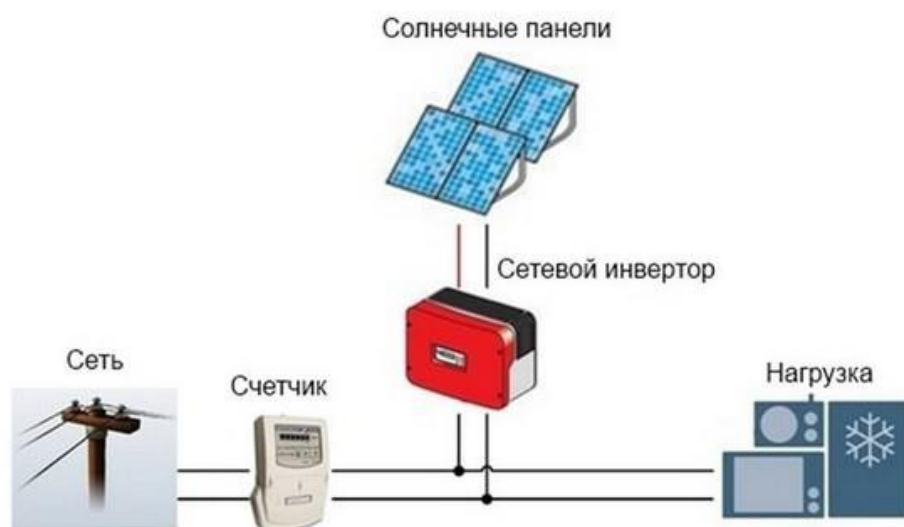
Рисунок. 2.1. Приклад підключення сонячних батарей для однофазних споживачів.
