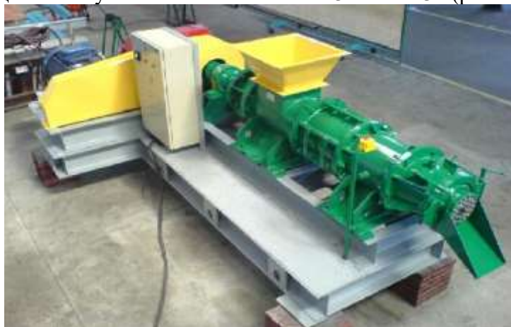
Рис. 2. Установка для изготовления композиционного угольного топлива (ХОТ-31)
