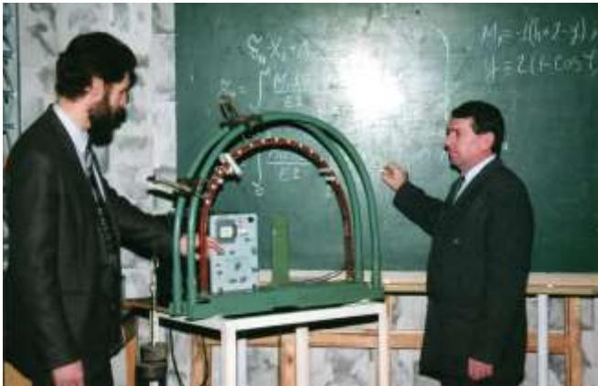
Исследование деформаций металлической крепи. Проф. А.Н. Роенко, доц. А.В. Солодянкин, 1997 год
