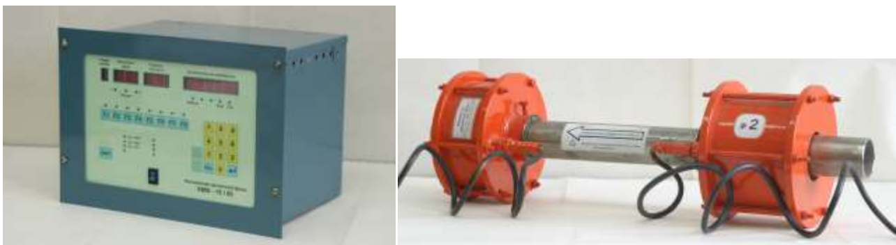
Рис. 4. Технические средства электромагнитного контроля процесса термоупрочнения арматурного проката – индикатор магнитной фазы (контроллер датчик магнитной фазы)
