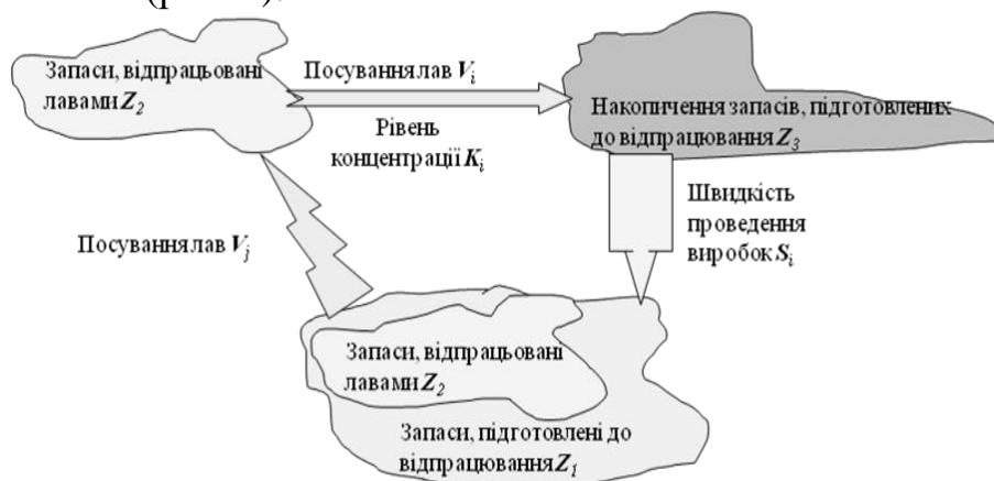
Рисунок 1 – Схема руху запасів при змінних швидкостях посування лав
