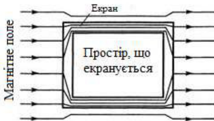
Рисунок 1.7 – Екранування магнітного поля феромагнітним екраном
