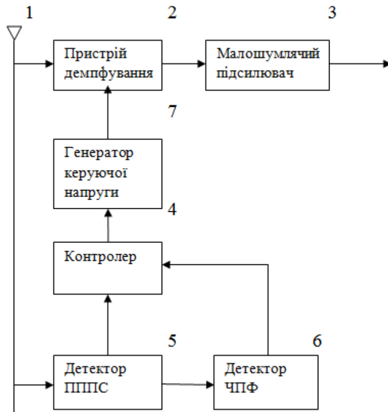
Рисунок 2.6 – Блок-схема для ілюстрації часткової структури абонентського терміналу системи мобільного зв'язку CDMA згідно другому розробленому способу
